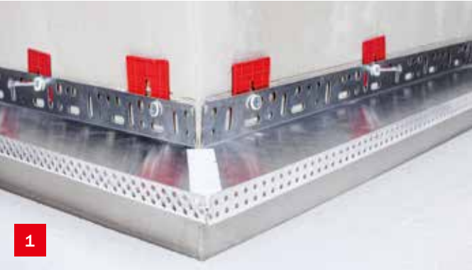
底座托架安装 用于保护系统底部，防水、防火、防止动物啃咬等，能有效保持外保温系统底部的清洁度和平整度，附有滴水功能，用于地基等溅水区域，以封闭和保护系统终端。
